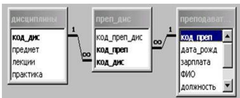
Рис. 5. Схема данных с использованием вспомогательной таблицы
